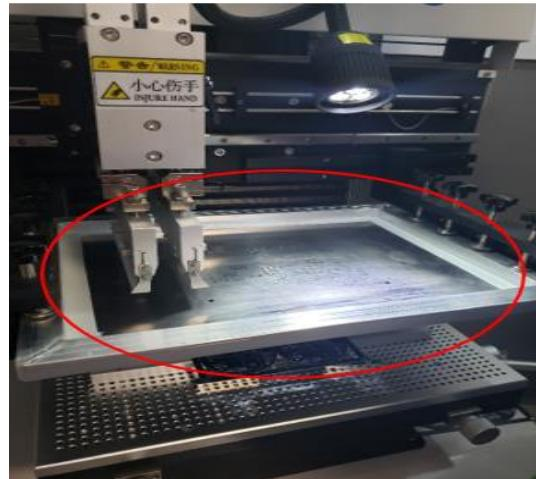
5.- Apretar los tornillos de sujeción cuidando que los dos tornillos de sujeción que se encuentran en esquinas contrarias
